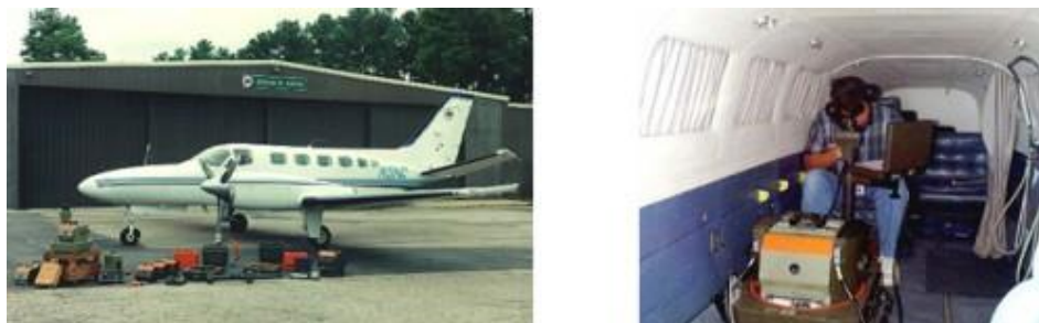
1-19. ábra A légi fotogrammetria eszközei. Balra: légifényképező repülőgép. Jobbra: a légifényképező repülőgép belülről a mérőkamerával és az operátorral
