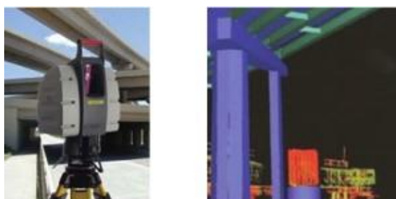
1-23. ábra A Leica HDS3000 lézerszkennер és a felmérés eredménye: háromdimenziós modellezés és megjelenítés
