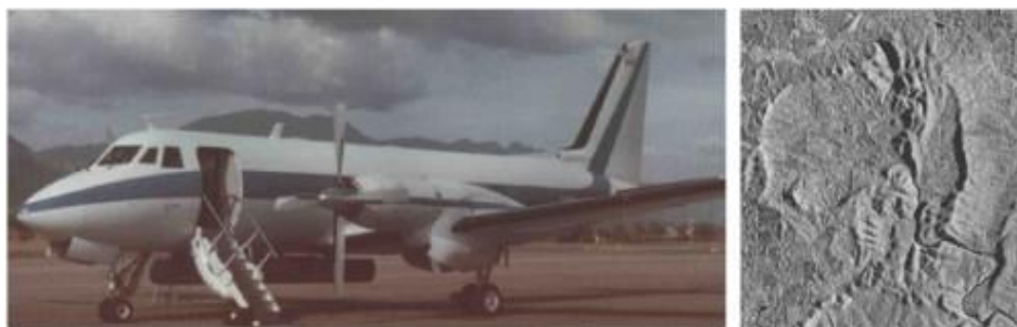
1-22. ábra Az SLAR rendszer. Balra: radar a repülőgép hasára erősítve. Jobbra: a radar kép, mint termék
