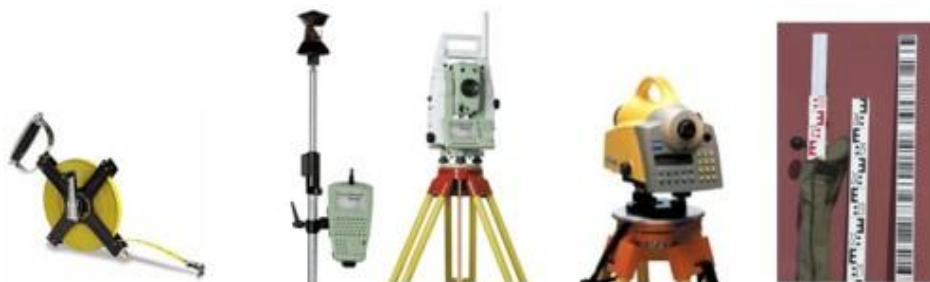
1-18. ábra A földi helymeghatározás mérőeszközei és műszerei: mérőszalag, mérőállomás, szintezőműszer és szintezőléc
